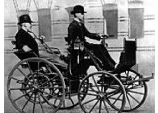
Das Besondere an diesen neuen Maschinen war, dass sie nicht mehr nach dem Prinzip der klassischen Dampfmaschine funktionierten. Nicht mehr das erhitzte Wasser, also der Dampfdruck, setzte etwas in Bewegung. Jetzt wurde eine Mischung aus Luft und Benzin in einem Zylinder immer wieder regelmäßig zum Explodieren gebracht. Und diese ersten Benzinmotoren übertrugen ihre Kraft auf eine Kette und dann auf das Antriebsrad.
